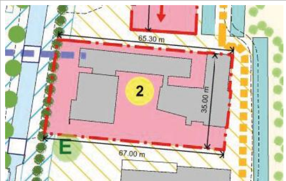
Abb. 4: Bebauungsplan neu, Baufeld 2 erweitert (inkl. Vermessung).
